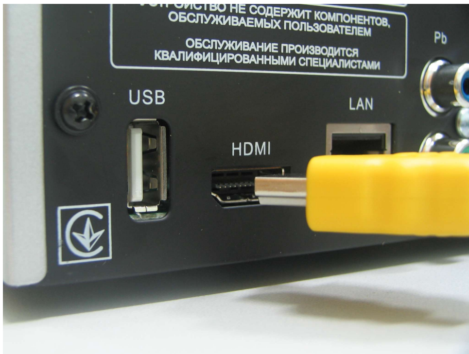
Rys. 4: Podłączenie telewizora za pomocą złącza HDMI
