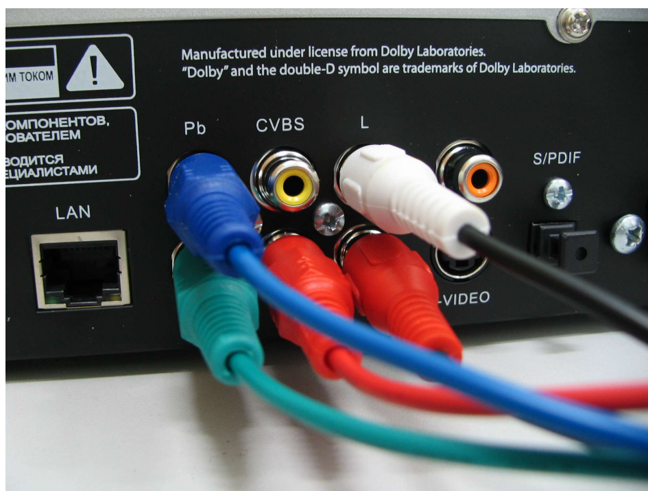
Rys. 5: Podłączenie telewizora za pomocą złącza Y-Pr-Pb
