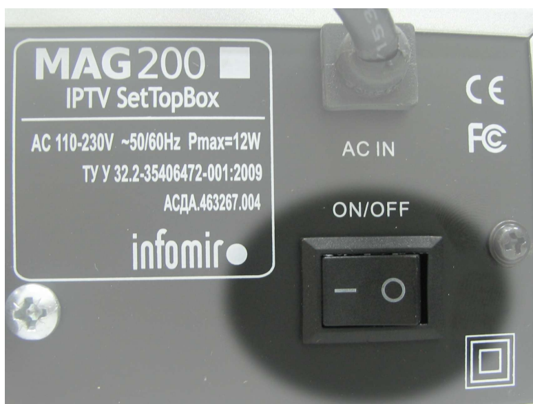
Rys. 10: Przełącznik w pozycji "1" (włączony)
