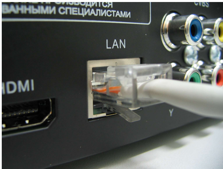
Rys. 8: Podłączanie STB do sieci LAN
