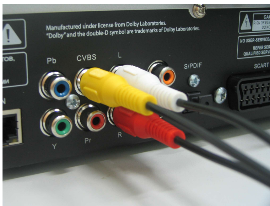
Rys. 7: Podłączanie telewizora za pomocą złącza CVBS
