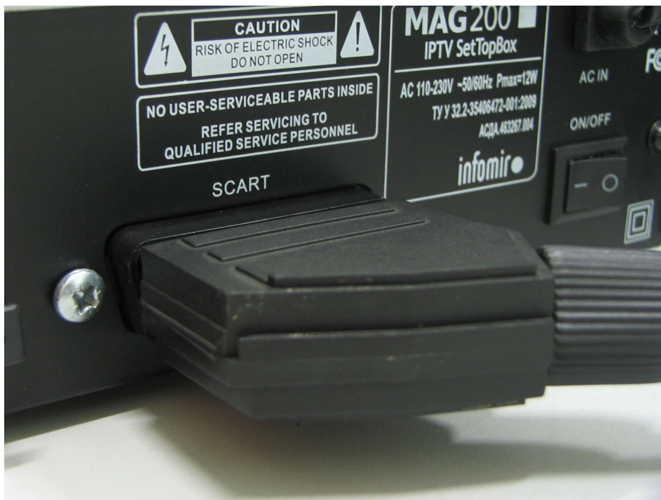
Rys. 6: Podłączanie telewizora za pomocą złącza EURO/SCART
