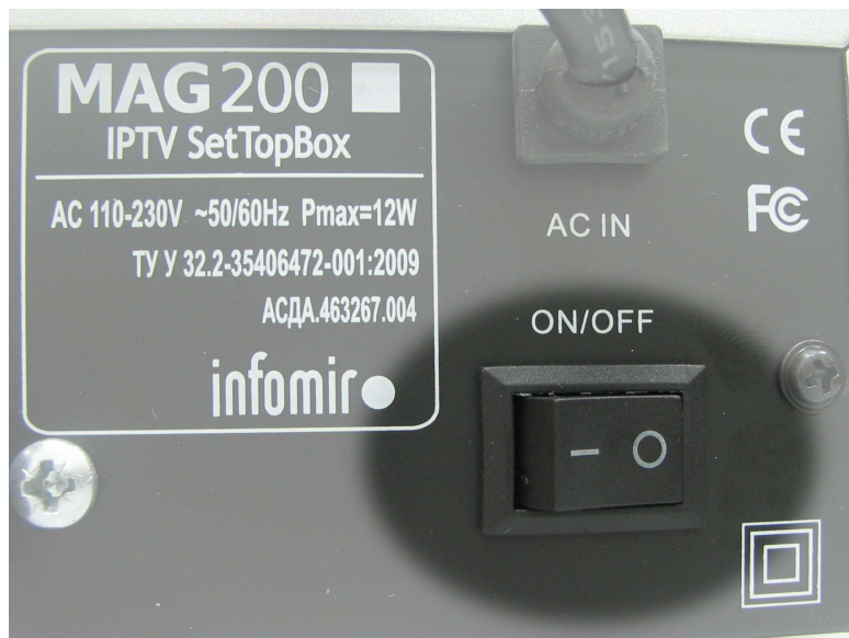
Rys. 9: Przełącznik w pozycji "0" (wyłączony)
